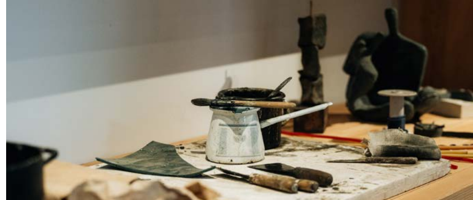
▲ Werkzeug und Wachs zum Herstellen eines Wachspostivs
