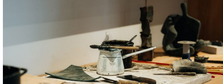
▲ Werkzeug und Wachs zum Herstellen eines Wachspositivs
